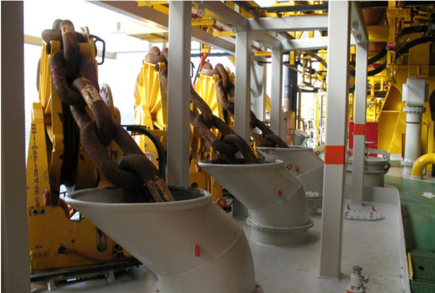
Pour maintenir un FPSO en place, il faut 16 ancrages au fond de l'eau (répartis par 4), aux extrémités du bateau. Ces chaînes sont tensionnées pour assurer le maintien de la plateforme flottante en place, malgré les effets de la houle, du vent et résister aux phénomènes météorologiques exceptionnels.
