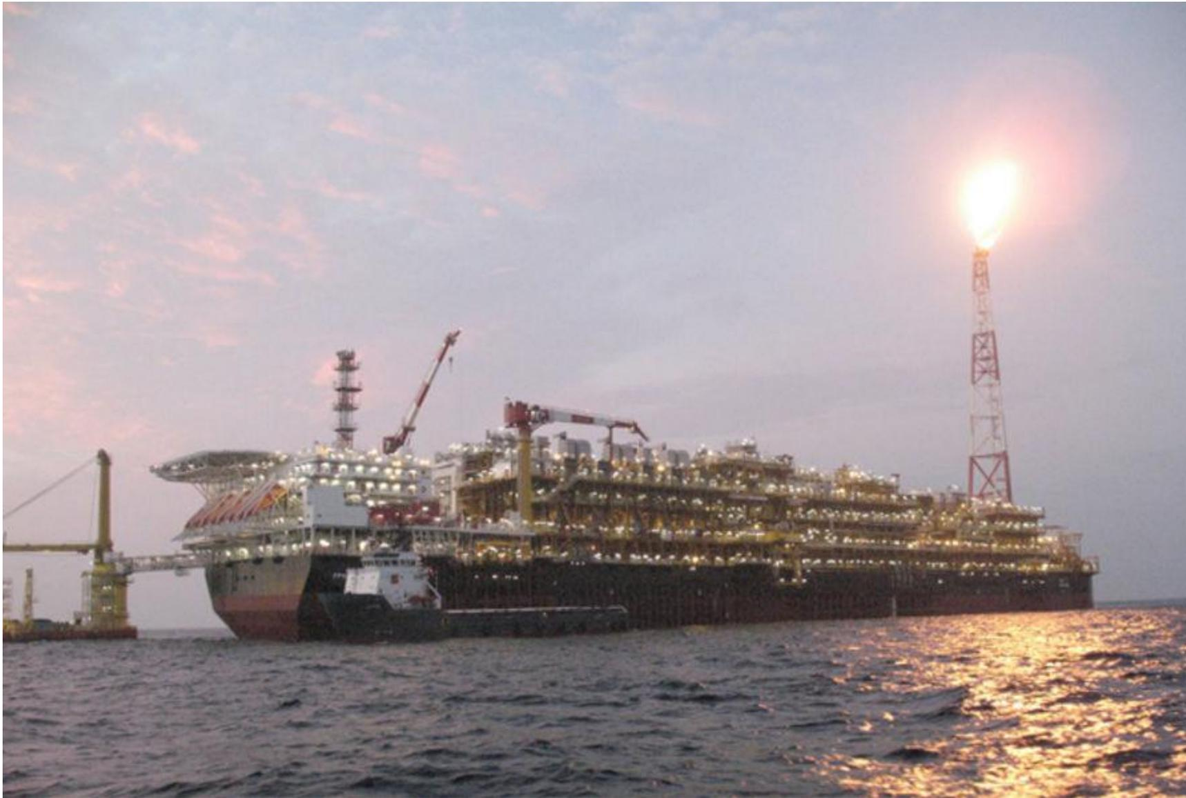
Construit en Corée par le chantier naval DSME (Daewoo Shipbuilding & Marine Engineering), le FPSO Pazflor mesure 325 m de long, sur 65 m de large, et pèse 120 000 tonnes à vide. Il exploite 4 champs pétroliers. Le projet lancé par TOTAL, en 2007, représente un investissement de 9 milliards US \$.
