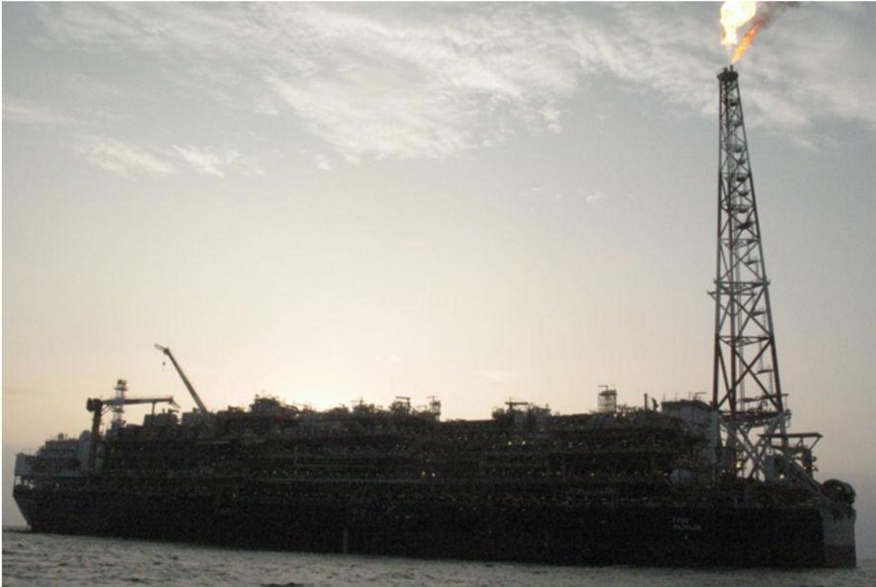
La torchère à la proue du bateau, crachait au début de la production des flammes de 20 mètres. A terme, ce gaz est réinjecté dans les réservoirs, pour remettre en pression, ou est envoyé vers l'usine de liquéfaction de gaz Angola LNG, en cours de construction en 2011.
